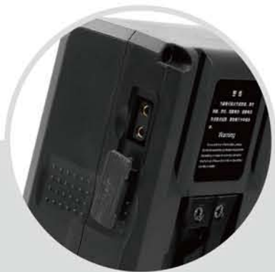
电池配备B型接口直流输出，额定电压14.8V，可为机头灯、监视器、无线传输等摄像机端设备供电。B型接口最高输出150W，10A。
